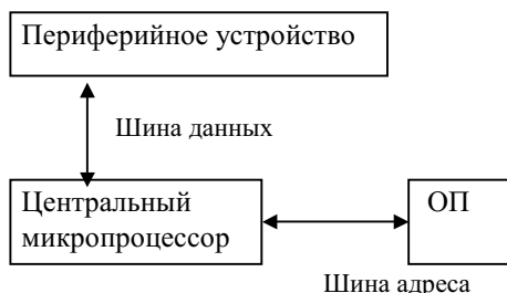
Рис. 2 Шина данных и шина адреса
